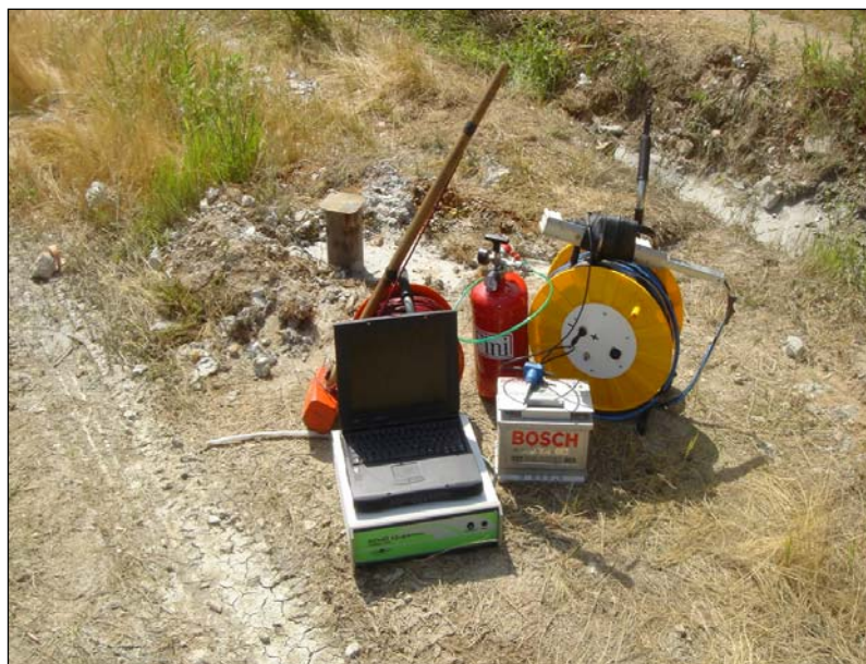
Foto 10 – Sismografo 24 canali Ambrogeo mod. Echo 24/2002 Seismic UNIT.
