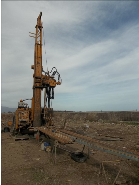
Foto 1 e Foto 2 – Sonda CMV MK 900 gommata posizionata sul sondaggio S 1 e S 2
