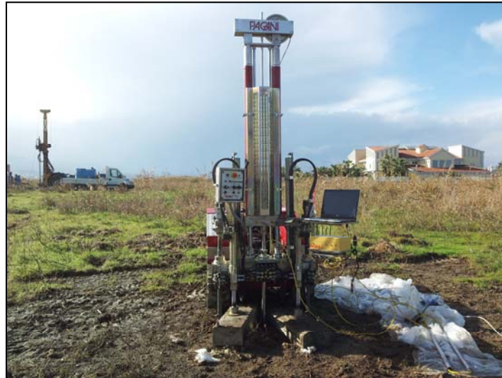
Foto 12 – Fase d’acquisizione dati prova SCPT.
