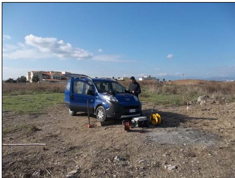
Foto 11 – Fase d’acquisizione tempi di propagazione onde Vp e Vs
