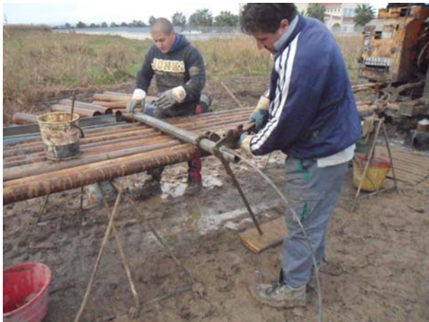
Foto 3 – Montaggio della sonda pressiometrica
